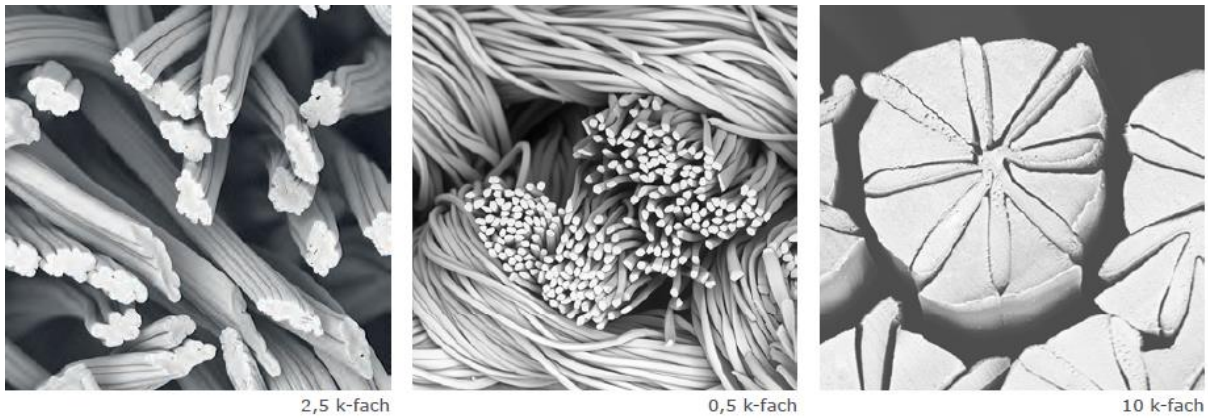
Abb. 3: Elektronen-Mikroskopische Aufnahme der Filamente des HiTech-Reinigungstuchs Typ VISCOT (links), SONIT MDM (Mitte), Microweb UDG (rechts).
